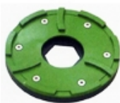
Для выравнивания перепадов на полу свыше 2 мм
