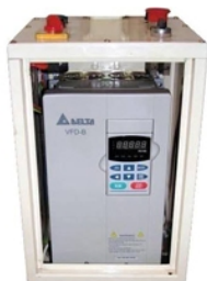
Инвертор для регулировки частоты вращения планшайбы.
